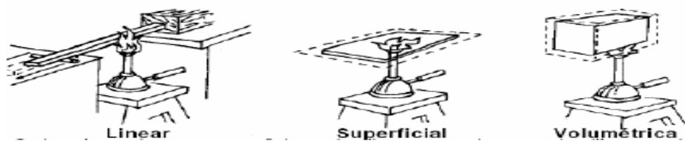
Cada substância tem seu coeficiente de dilatação térmica, ou seja, dilatam mais ou menos dependendo da substância. Este fator pode acarretar alguns problemas, como por exemplo, uma viga de 10m exposta a um aumento de temperatura na ordem 700º C. Com esse aumento de temperatura, o ferro, dentro da viga, aumentará seu comprimento em 84mm aproximadamente, o concreto, apenas 42mm.
